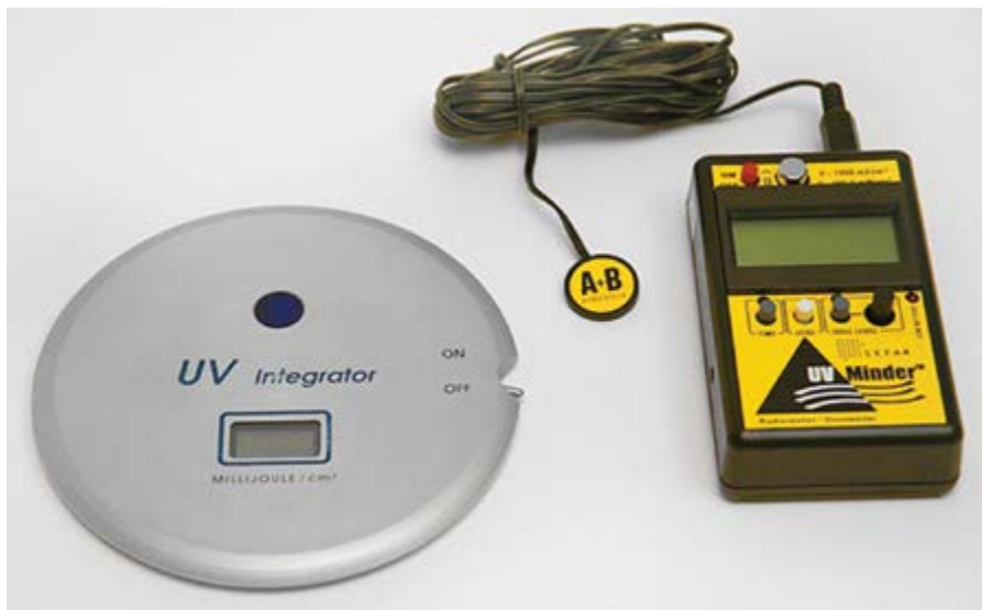
辐射计可以检测曝光灯管的有效性
