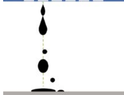
卫星墨滴导致水滴落在承印材料或环境中的错误位置
