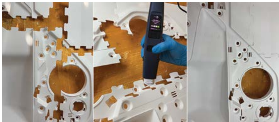
在用环氧树脂粘合单个 3D 打印部件之前进行预处理，有助于最终产品结构粘合牢固
