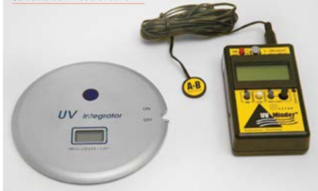
使用辐射计检查曝光灯的效率
