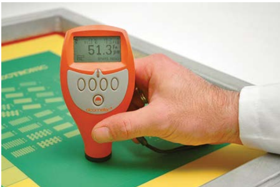
使用涂层厚度计测量厚度
