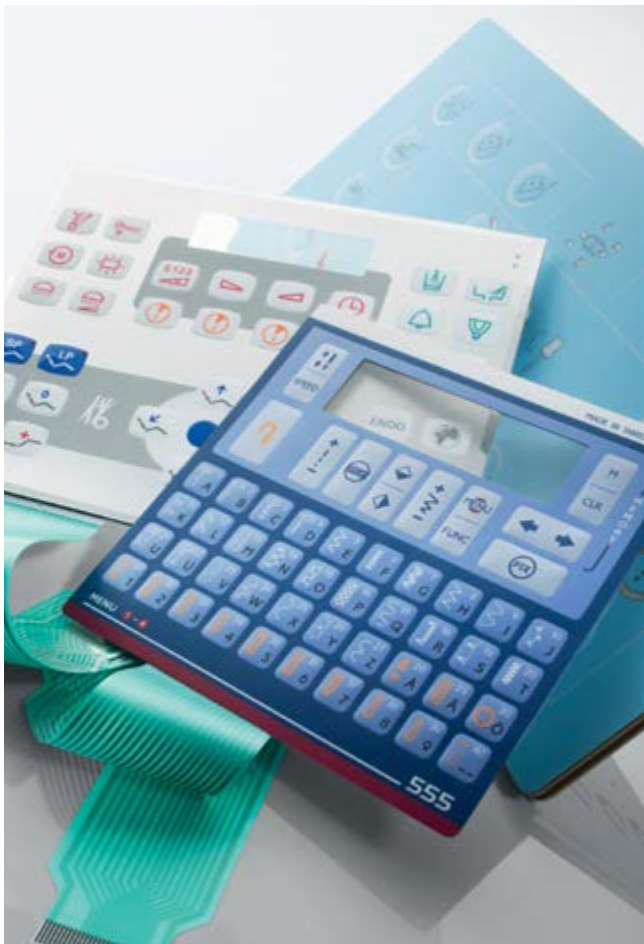
薄膜开关具有 PET 薄膜承印物，通过丝网印刷和数字印刷组合方法进行印刷
