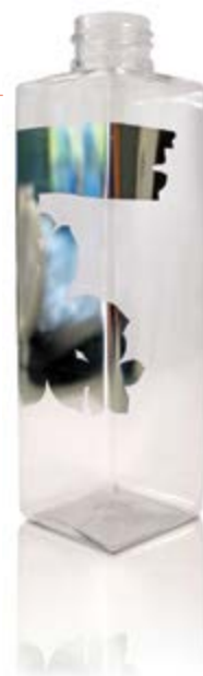
在方形塑料瓶上进行 inLINE FOILING - 如果拐角半径不是太小, 则在拐角处也可进行箔印
