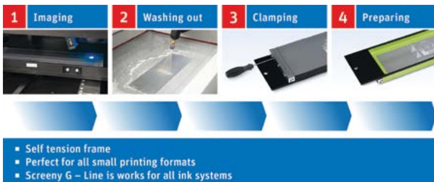
Screeny C-Line 丝网印版仅需四步即可进行印刷：曝光、显影、张紧和准备（密封丝网）。此过程耗时不到 10 分钟。
