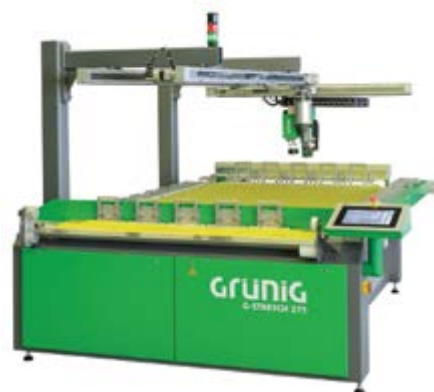
G-STRETCH 275 是全自动拉伸机，具有自动上 UV 胶和 LED 固化功能。
