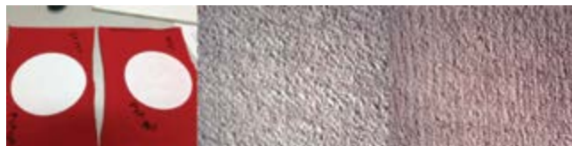
图 4 - 细线丝网印刷与标准丝网印刷的染料泳移对比 (图片由来自 Saati Americas Corp 公司的 Eric Klein 友情提供)
