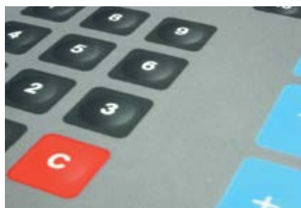
一种典型的丝网印刷薄膜开关板
