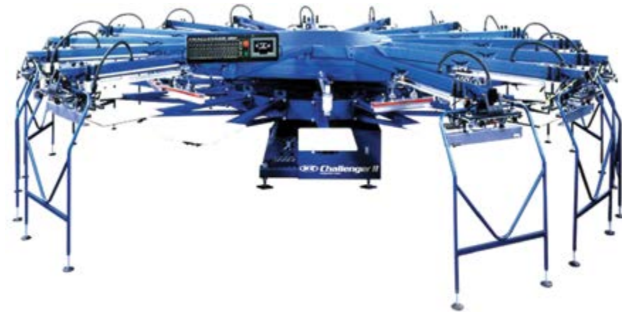
通过转动印刷机（闪光灯开启）对托盘进行预热，直至温度达到上次生产所用的数值。
