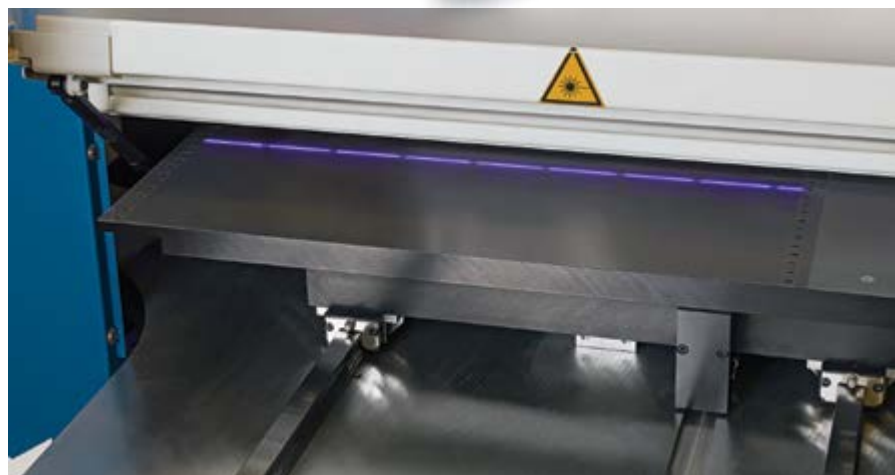
使用 Gallus Screeny C-Line 只需四个步骤即可在六分钟内准备好可以即时可用的印刷丝网。第 1 步——剥去预敏化 Screeny 板上的保护膜；第 2 步——使用菲林或 Cts-UV 对 Screeny 板进行曝光；第 3 步——用自来水洗掉图像，并干燥丝网板；第 4 步——将添加了图像的丝网固定在快速加热框架中。
