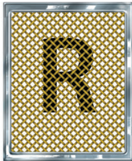
图四：如果图案垂直和水平线条元素区域无法使闪光油墨顺利通过，斜铺丝网能减少部分筛孔问题。
