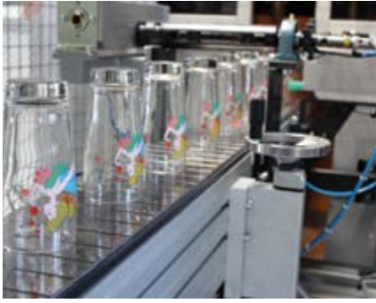
出料输送带上使用UV 油墨印刷的玻璃杯。这些杯子已准备好打包。
