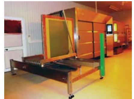
将 G-Wash 175 XS 与 STM-TEX 整合成为一套完善的 CTS 及开发线
