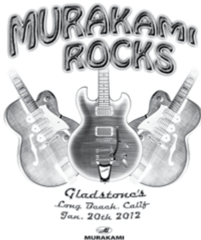
模拟工艺印刷用基版示例。基版的专色区域非常少，因为大多为半色调
