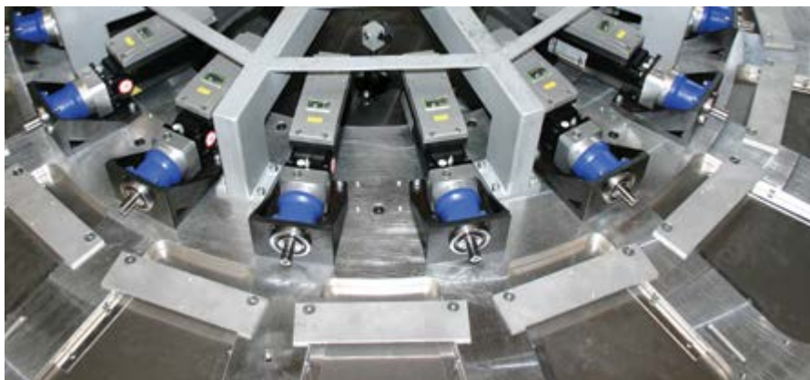
RS 7480 分度环上的伺服马达。每个伺服马达都会独立驱动其对应的固定装置
