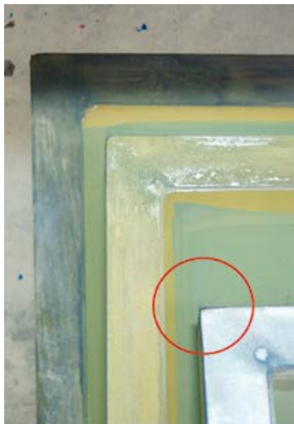
框角会损坏细网孔
